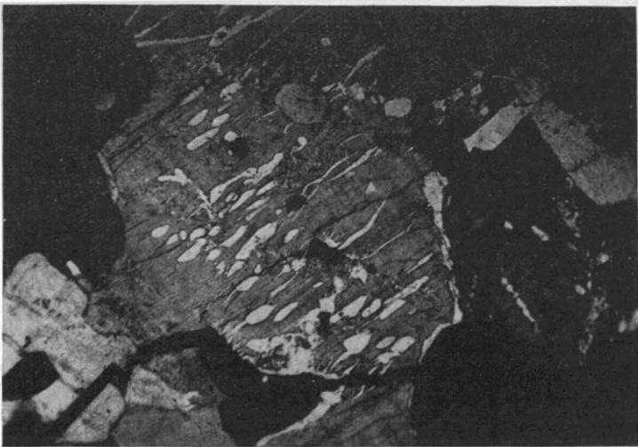
FIG. 7 — Phénomènes d'exsolution (deutériques) dans un granite de Pine Hill du lac Cœur, Ripon, Cté de Papineau; échantillon 120; diam. 40x.
