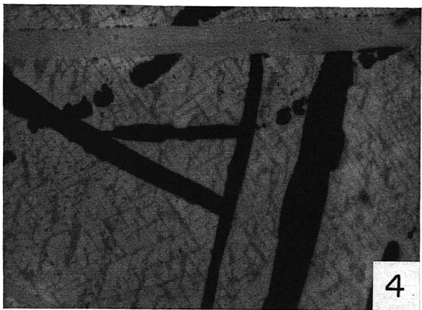
Photo 3.—Agrégat de magnétite (blanc), de TiFe_2O_4 (gris) et d'hercynite (lamelles noires). Grossissement: 2,000 x
