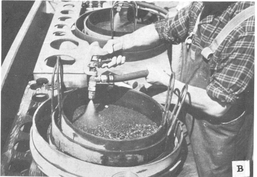
FIGURE 4. Traitement à bord du bateau des échantillons endobenthiques prélevés avec l'échantillonneur de fond Holme. (A) Le godet, débordant d'une vase cohésive qui a collé à sa paroi alors qu'il pivotait dans le sédiment, est retiré de l'échantillonneur et transporté vers les tamis. (B) La vase est désagrégée, par un jet d'eau finement pulvérisé, dans une série de trois tamis superposés, à mailles de dimensions décroissantes, placés sur des tables percées d'une grande ouverture laissant couler l'eau et la vase débarrassée des animaux.
