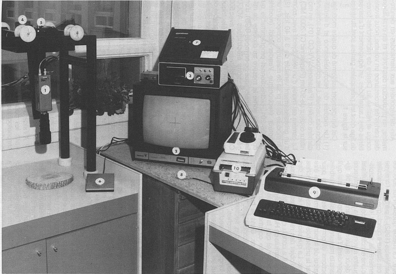
Figure 1. Équipement d'analyse de tige: (1) caméra, (2) moniteur, (3) compteur électronique, (4) générateur de pulsations électriques, (5) moteur électrique, (6) interrupteur de mouvement, (7) interface programmable, (8) bouton d'acquisition, (9) imprimante et (10) enregistreuse.
