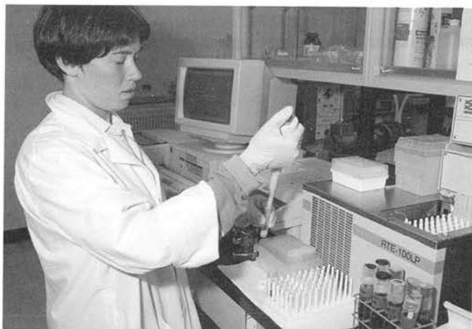
**Cet appareil analyse la toxicité des sédiments marins en mesurant la diminution de la bioluminescence de la bactérie marine *Vibrio fischeri*. On sait que la présence de contaminants inhibe la luminescence de cette bactérie.**
