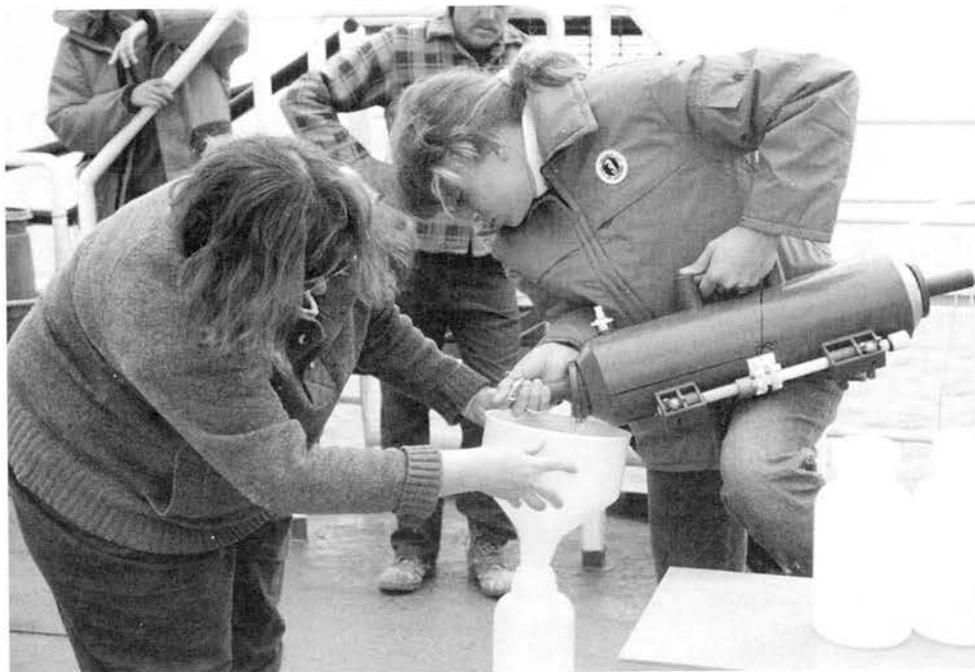
**Les chimistes de l'IML recueillent des échantillons d'eau dans l'estuaire du Saint-Laurent à l'aide d'une bouteille Niskin qui permet de capter l'eau à une profondeur prédéterminée. L'eau sera ensuite filtrée et les micro-organismes qui s'y trouvent seront analysés pour déceler la présence de contaminants.**
