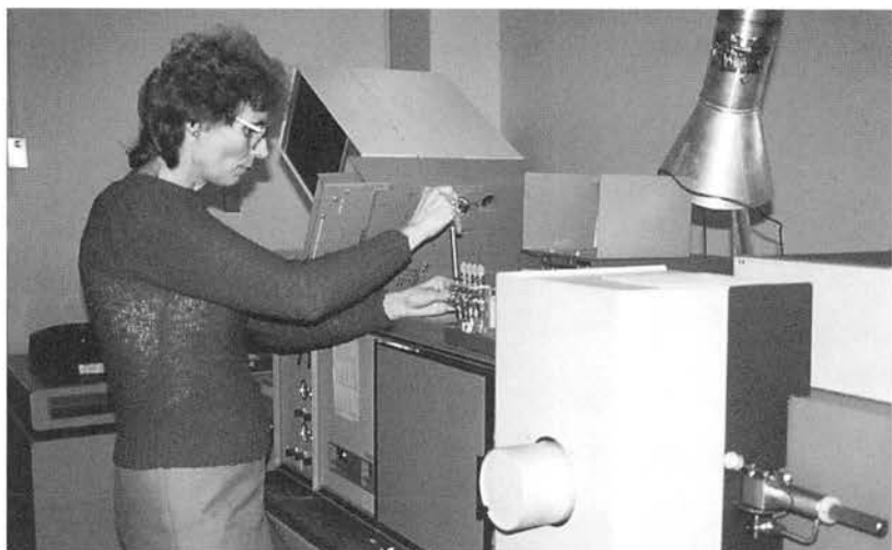
Sur cette photographie de 1989, Mary Simon injecte un échantillon dans un spectromètre de masse, au Centre national de la recherche faunique, pour l'analyse à l'état micro-trace de contaminants organiques.
