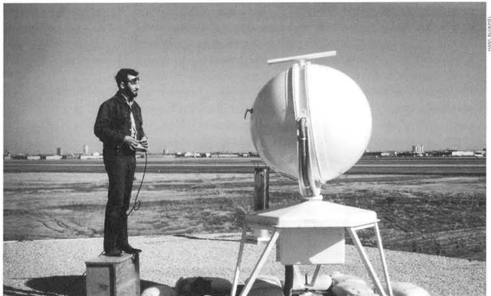
Le travail de Vic Solman et de Hans Blokpoel sur le moyen d'éviter les collisions d'aéronefs avec des oiseaux a mené à des innovations pour l'utilisation d'équipement. Ici, l'étudiant d'été Wayne Gemmill oriente un radar, généralement utilisé pour suivre des ballons météorologiques, vers un « voilier » d'oies des neiges en migration.
