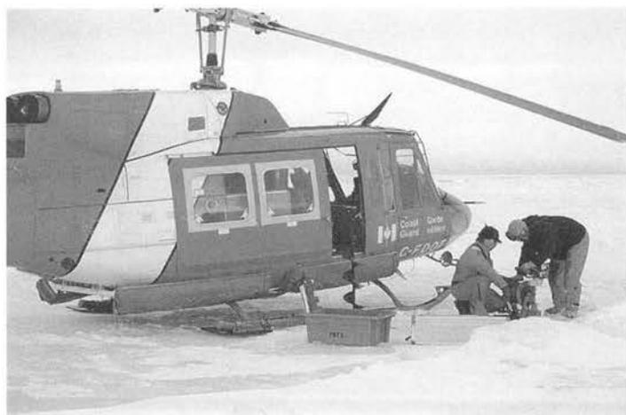
**Après avoir creusé un trou dans la glace du golfe et mouillé un instrument pour mesurer la température et la salinité de l'eau, l'équipe utilise le moteur de la perceuse à glace pour remonter l'instrument à l'aide d'un treuil.**
