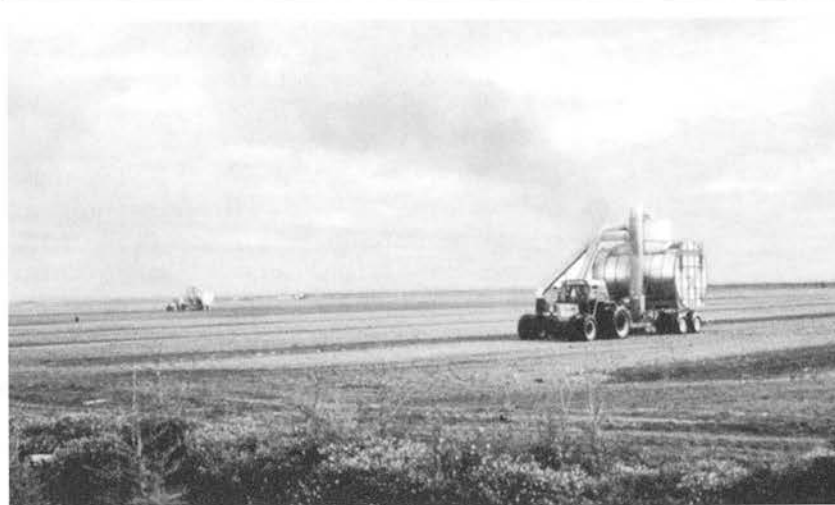
Figure 4. Récolte mécanisée de la tourbe à l'aide d'aspirateurs sur de très grandes surfaces.
