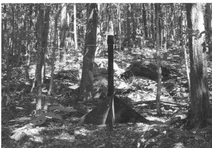
Figure 2. Piège cylindrique mis à l'essai imitant la silhouette d'un tronc d'arbre.
