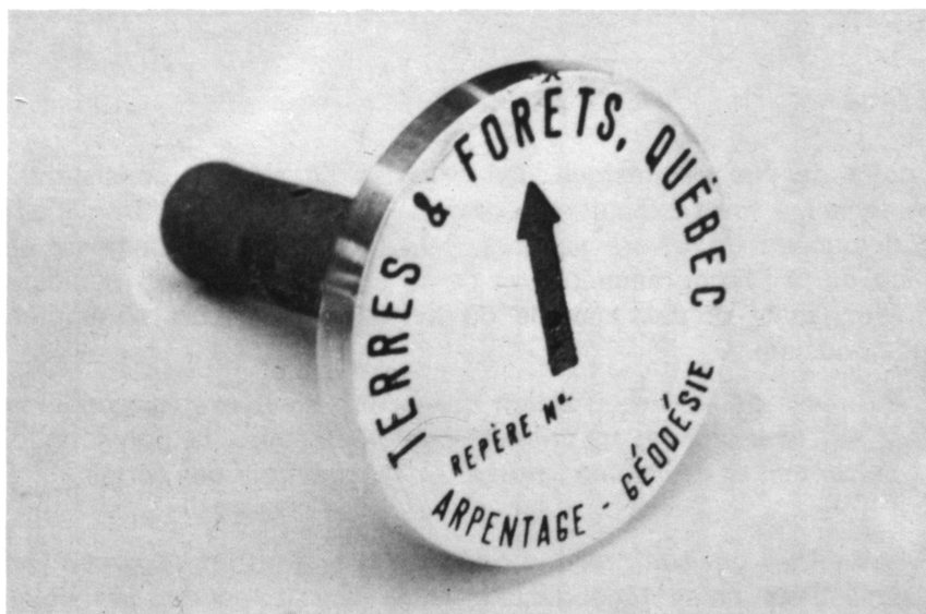
Repère auxiliaire témoin dont la flèche sert à indiquer la direction d'un point géodésique installé à proximité.
