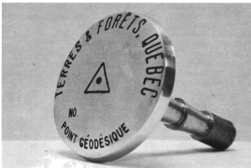
Repère servant à matérialiser un point géodésique
