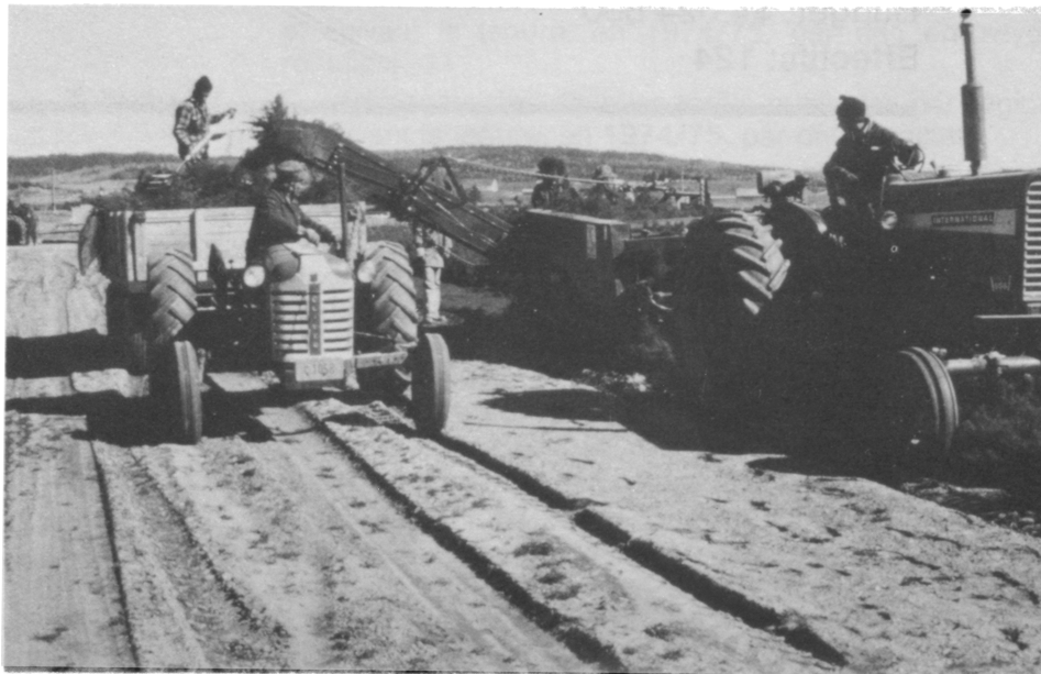
Figure 14 — Extraction mécanisée de plants en pépinière.
