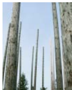
Poteaux traités avec un nouvel additif polymère.
