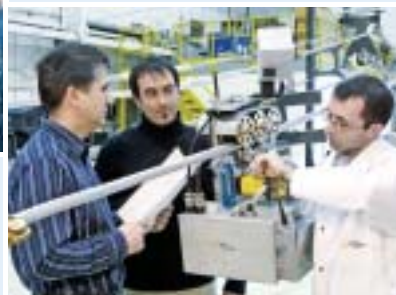
Le LineROver, un robot pour l'inspection des lignes de transport, développé à l'Institut de recherche d'Hydro-Québec.
