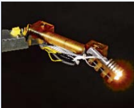
Sonde mise au point par l'Institut de recherche d'Hydro-Québec pour le robot d'inspection télévisuelle utilisé à la centrale nucléaire de Gentilly-2. Elle est munie d'une caméra et permet d'inspecter à distance les composants du réacteur.
