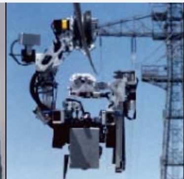
LineScout, un robot pour l'inspection des lignes de transport sous tension, développé par l'Institut de recherche d'Hydro-Québec. Il peut franchir des obstacles comme les chaînes d'isolateurs.
