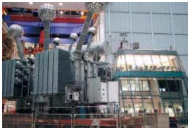
Transformateurs de puissance d'ABB testés dans la nouvelle aire d'essais de l'Institut de recherche d'Hydro-Québec.
