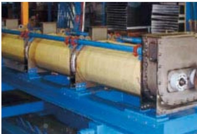
La mine Niobec, au Saguenay, a reçu un prix Énergie pour l'intégration à ses procédés d'un convoyeur à vis chauffée par induction développé par notre Laboratoire des technologies de l'énergie.
