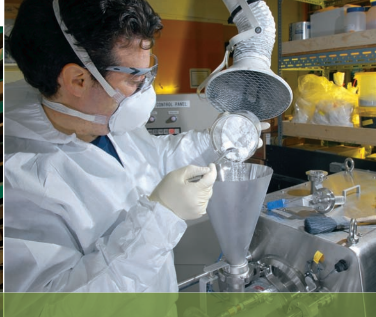
À l'Institut de recherche d'Hydro-Québec, travaux en cours sur les sels fondus qui seront utilisés dans la fabrication de batteries au lithium-ion destinées aux véhicules électriques.
