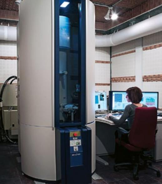
L'IREQ se sert du MEBT pour développer des nanomatériaux destinés aux batteries et pour étudier le vieillissement des équipements du réseau, notamment.
