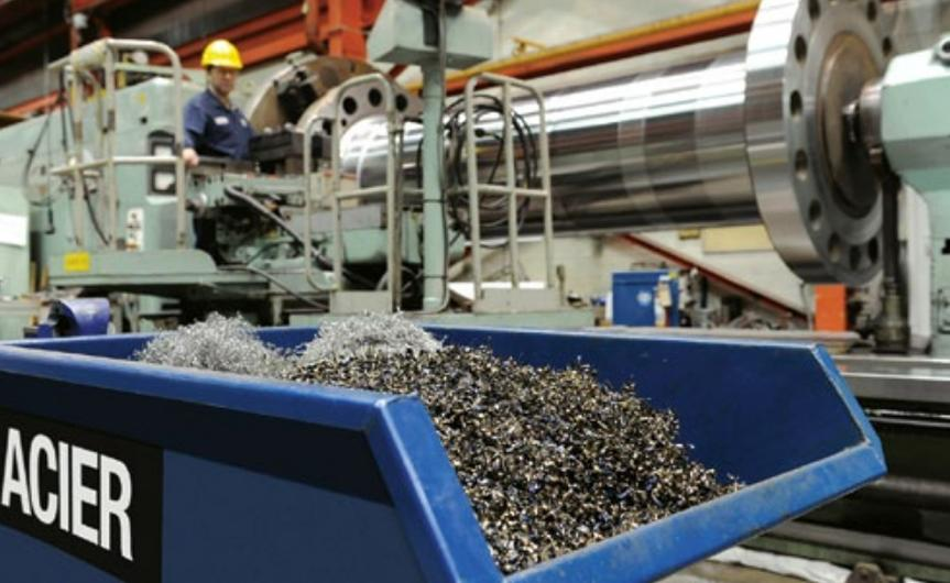
Jean-Pierre Grenier, chef mécanicien d'appareillage à l'atelier mécanique de Shawinigan, en Mauricie, usine l'arbre de l'une des turbines de la centrale de Beauharnois au moyen d'un tour horizontal. Les copeaux d'acier, de même que les rebuts d'aluminium et de bronze de l'atelier, sont recyclés au lieu d'être envoyés à l'enfouissement.
