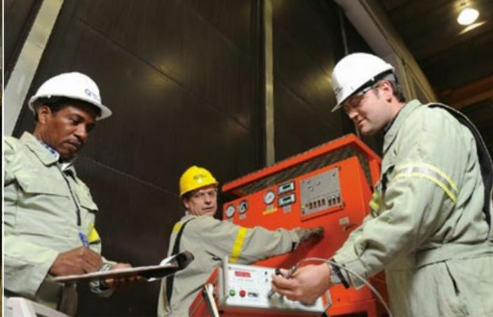
Les transformateurs du poste de Langelier, à Montréal, sont isolés à l'hexafluorure de soufre (SF<sub>6</sub>). Luckner Verna, technicien – Soutien technique, Jean-Luc Gadoua, chef électricien d'appareillage, et Mathieu Lalonde, ingénieur électrique, utilisent un hygromètre et un système de récupération pour vérifier la qualité du SF<sub>6</sub>.
