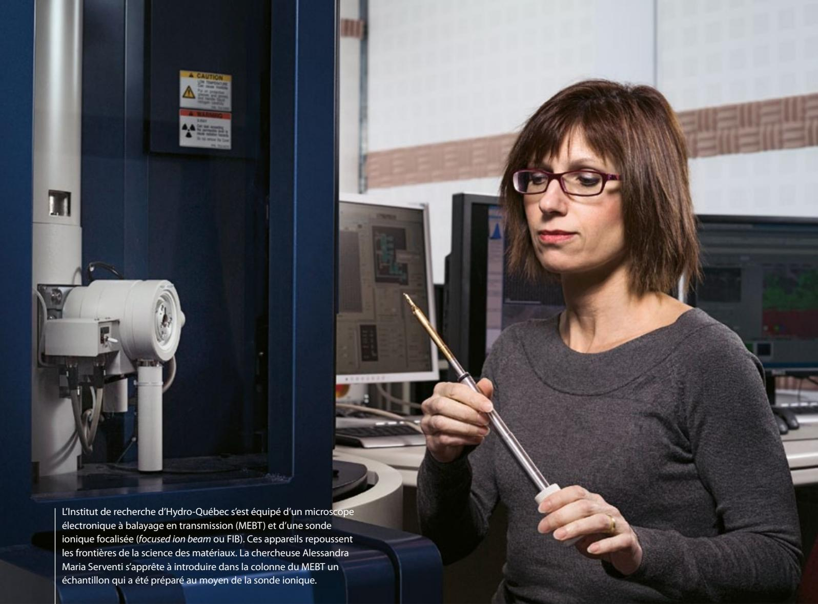
L'Institut de recherche d'Hydro-Québec s'est équipé d'un microscope électronique à balayage en transmission (MEBT) et d'une sonde ionique focalisée (*focused ion beam* ou FIB). Ces appareils repoussent les frontières de la science des matériaux. La chercheuse Alessandra Maria Serventi s'apprête à introduire dans la colonne du MEBT un échantillon qui a été préparé au moyen de la sonde ionique.
