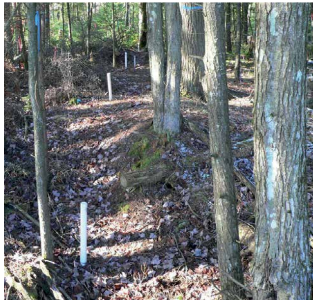
Aperçu de la pessière rouge à sapin de basse terre et du puits d'observation de la nappe phréatique creusé dans un secteur témoin (non coupé) afin d'estimer l'effet de la coupe progressive d'ensemencement sur la remontée du niveau de la nappe phréatique (Photo : M. Prévost, MRN).
