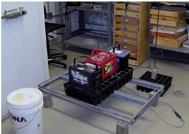
Prototype de balance électronique à l'essai au laboratoire. Cette balance mesure, en temps réel, la teneur en eau du substrat de plusieurs récipients à la fois (un plateau de culture); les données sont transmises par un système de communication sans fil. Cette balance permettra d'ajuster l'irrigation des plants en récipients en fonction de leurs besoins réels en eau (Photo : D. Girard, MRN).
