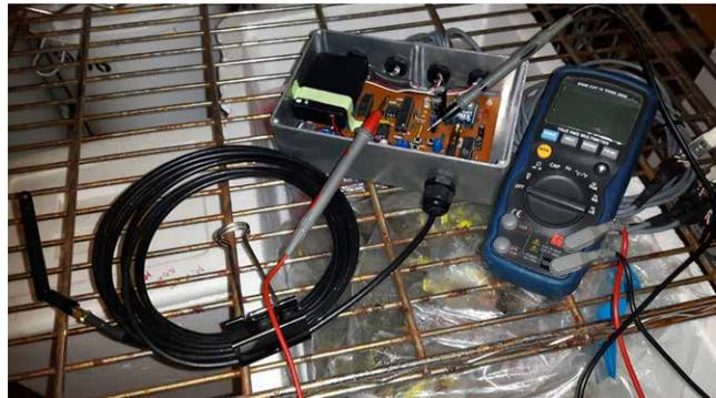
Les composantes électroniques des balances ont été testées avec succès en pépinières et en laboratoire sous des conditions extrêmes (congélateur à  $-20^{\circ}\text{C}$ ) avec une alimentation de 3 piles alcalines AA (Photo : D. Girard, MFFP)
