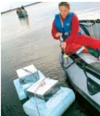
Chambres flottantes pour mesurer les GES.
