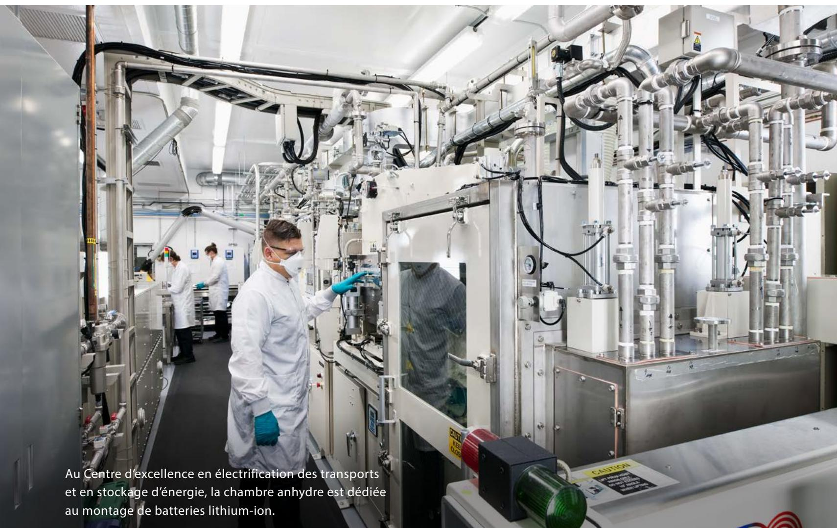
Au Centre d'excellence en électrification des transports et en stockage d'énergie, la chambre anhydre est dédiée au montage de batteries lithium-ion.
