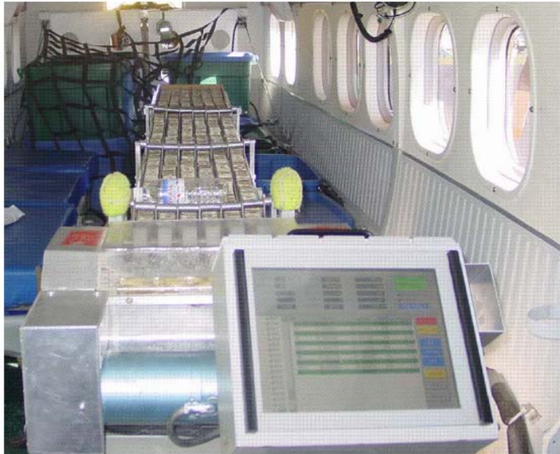
Figure 11. Courroie de largage des appâts vaccinaux à l'intérieur de l'avion (Photo : D. Lamarche, MRNF-06).
