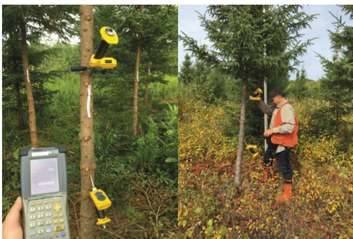
Figure 1. Mesure de la vitesse acoustique sur un arbre sur pied (Photos : Pier-Luc Faucher, MFFP).
