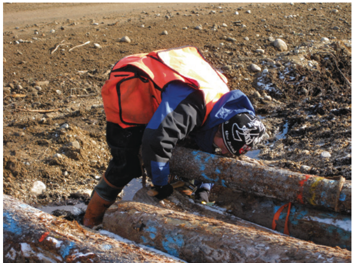
Figure 2. Mesure de la vitesse acoustique sur une grume (photo : Julie Barrette, MFFP).
