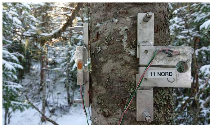
Figure 2. Jauges de contrainte fixées orthogonalement sur le tronc d'un sapin baumier
