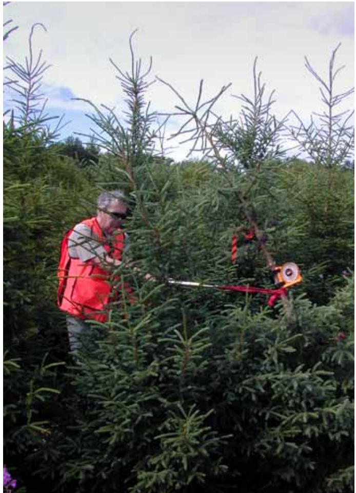
Figure 1. La stabilité mécanique des plants a été évaluée en appliquant une force horizontale en direction des quatre points cardinaux.
