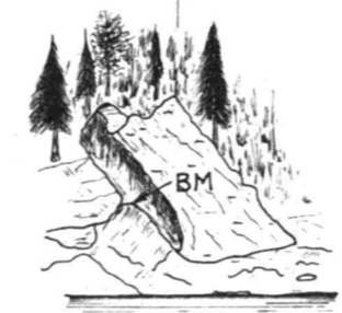
BM. N° 3, EL = 368.71 Sur le roc solide, du côté droit de la rivière, à un endroit où la rivière forme un petit lac, à environ 1/4 de mille en amont de la rivière Boisbouscache.
