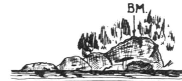
BM. N° 4, EL = 164.43 Sur une pointe de rocher, du côté droit de la rivière à environ 100 pieds en amont du moulin Gagnon.
