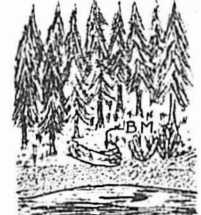
B.M. N°14 Haut. 363.72 Sur un quartier de rocher de la rive Est au bout d'un chemin de portage à un mille en aval du ruisseau Square Forks.
