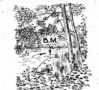
B.M. N° VI cote -1038.73 Sur le haut de la falaise de roc rive droite bordant la tête du rapide N°18.
