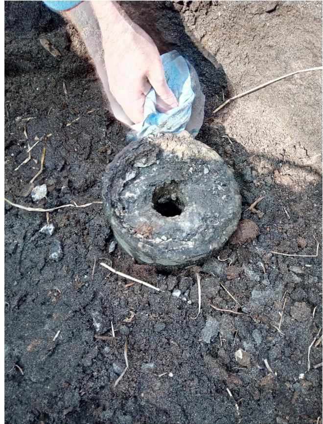
**Figure 3 :** Vue des tubages à la surface du puits A102 après avoir retiré le couvercle de métal, le 22 septembre 2020.
