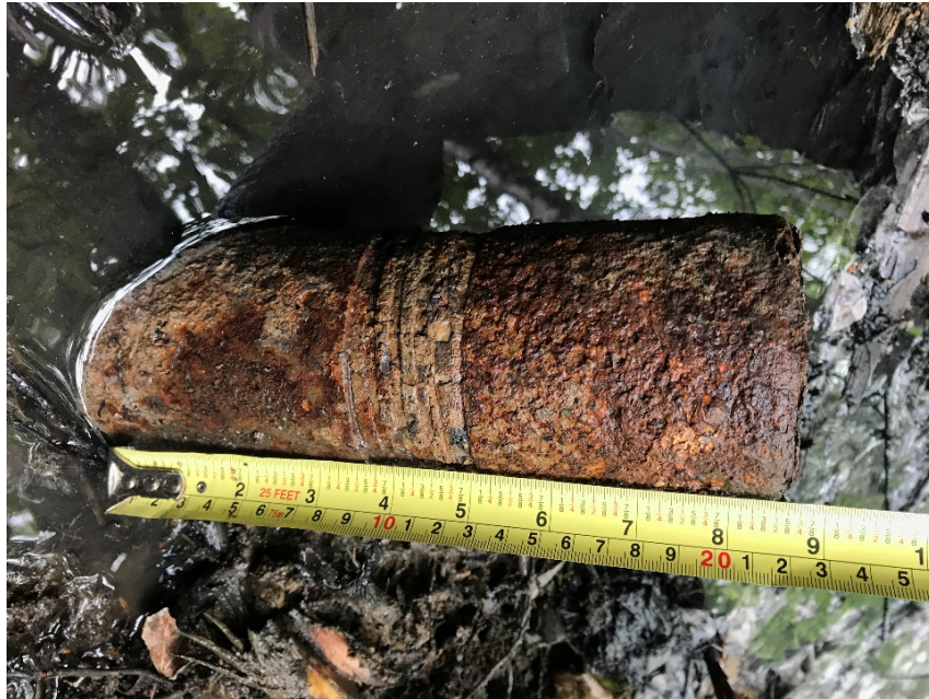
Figure 8 : Tubage de 88,9 mm corrodé au puits CS34 le 30 juin 2020.
