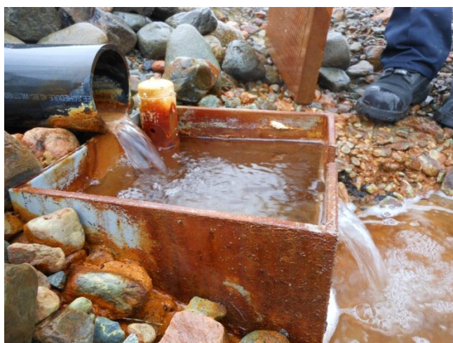
Figure 44 : Bac Vnoch pour mesurer des débits
