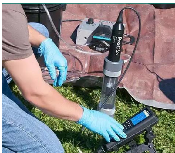
Figure 3 : Sonde multiparamètres immergée dans une cellule de mesure fermée (ysi.com).
