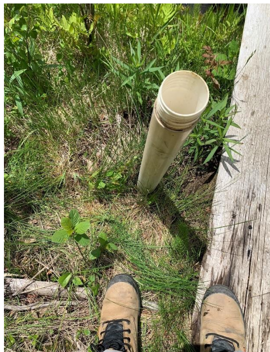
Photo 12 : Aménagement typique d'un puits d'observation de la pépinière (ici BE-19).
