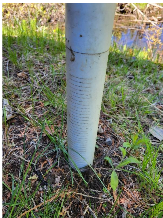
Photo 20 : Détail des crépines hors-sol de BE-24 et de l'absence de sable ou de bentonite autour.
