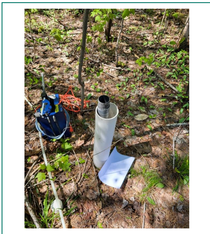
Photo 3 : BE-13 avec les tubages supérieurs retirés.
