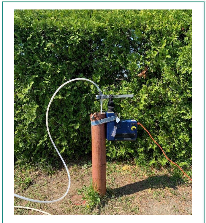
Photo 4 : SM-20 vue direction S-O avec un actionneur de tubage pour le développement.
