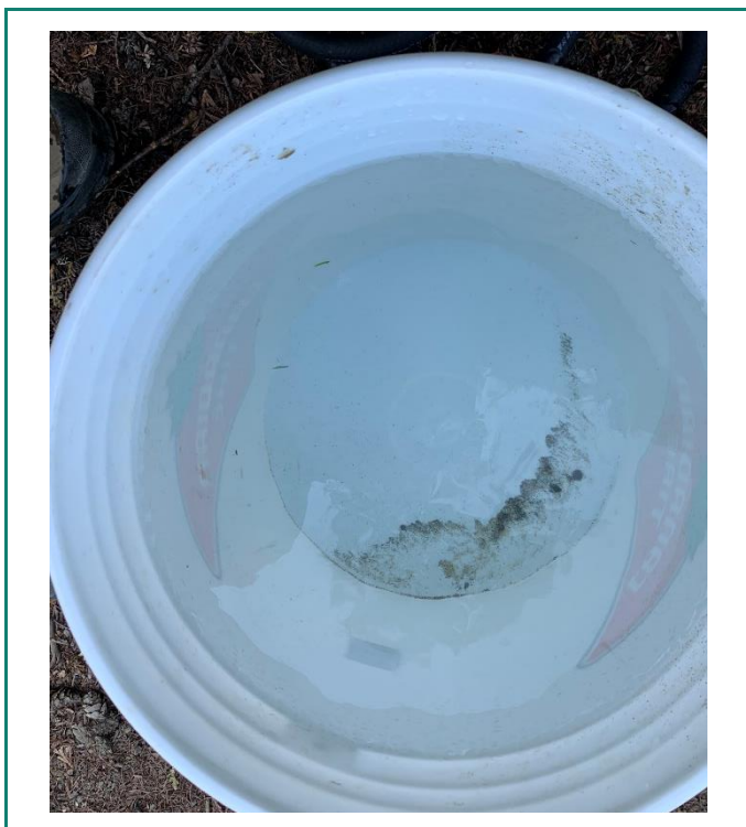
Photo 7 : GP-11I : aspect de l'eau après quatre passes de développement et le court essai de pompage (fin des essais).
