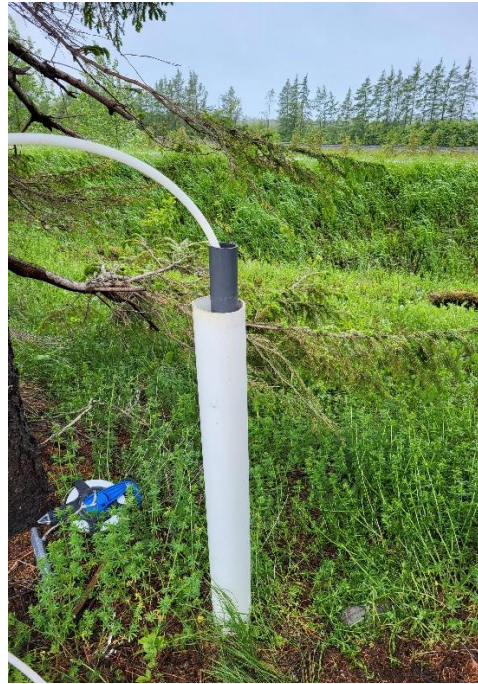
Photo 2 : SL-22 avec le tubage protecteur retiré. Tubage interne et tubage protecteur typiques de l'ensemble des pépinières publiques
