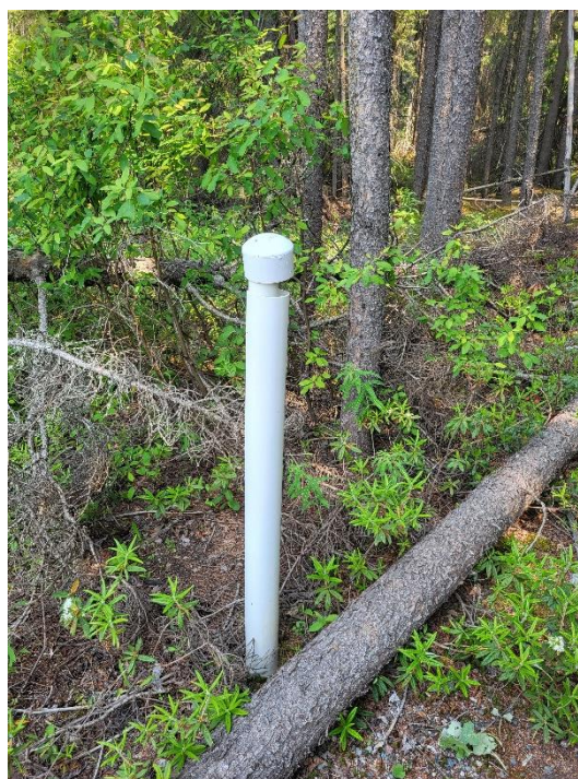
Photo 11 : TR-16 vue direction E. Le tubage interne dépasse du tubage protecteur.
