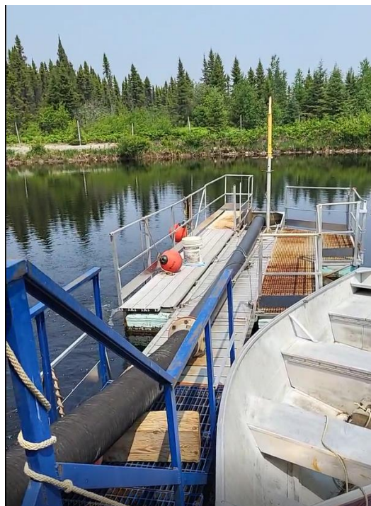
Photo 15 : Équipement de pompage dans le lac pour l'irrigation des cultures.
