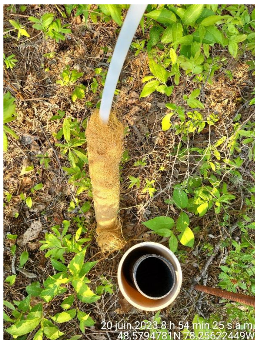
Photo 3 : TR-10. Racines accumulées autour de la tubulure.
