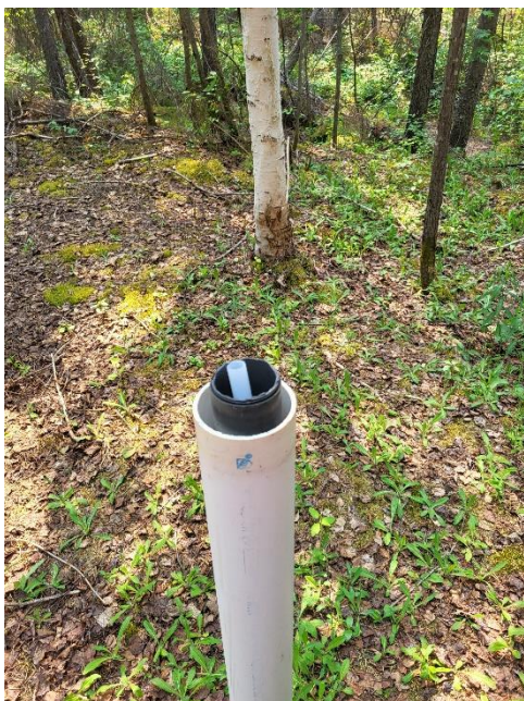
Photo 5 : Détail de TR-11. Exemple du tubage interne et du tubage protecteur typique des puits d'observations de l'ensemble des pépinières publiques.
