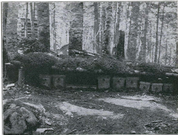
FIG. 2.— Abri sous lequel sont placées les boîtes d'émergence. La petite boîte plus longue et plus étroite que les autres contient deux thermomètres Tycos, l'un à minimum et l'autre à maximum, qui se trouvent ainsi dans des conditions identiques aux cocons.
