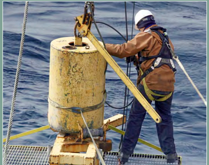
Mise à l'eau du carottier à gravité, p. 41
