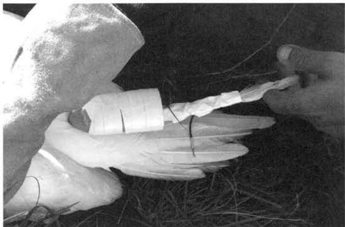
Figure 6. Photographie montrant comment l'enregistreur de données géographiques, pesant près de 70 g, est fixé avec du ruban aux deux plumes centrales de la queue d'un fou de Bassan. On aperçoit également l'extrémité de la sonde mesurant la température et la pression de l'eau, orientée vers le bas.
