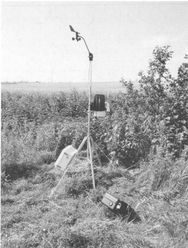
Figure 5. Station météorologique et Anabat MC SD1 dans un caisson étanche déployés sur le terrain.
