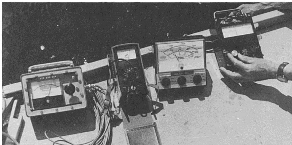
*Instruments portatifs de g. à d.: thermomètre à thermistor, pH-mètre, conductivimètre, O.D.-mètre.*
