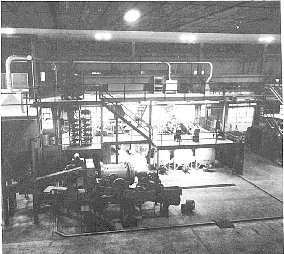
*L'Usine-pilote du ministère: Broyeurs de minerai à l'avant plan; au-dessus: spirale de concentration; et à droite: réservoirs superposés.*
