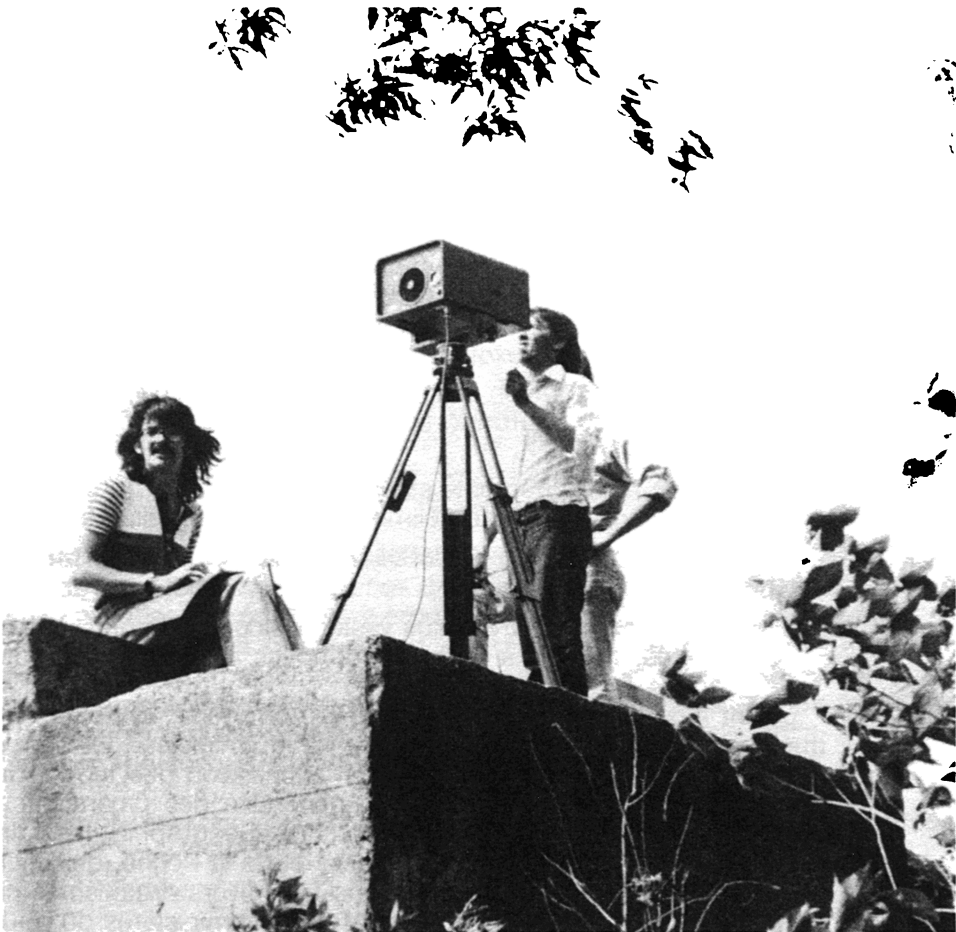
Mesure de distance au télémètre électronique à laser.
