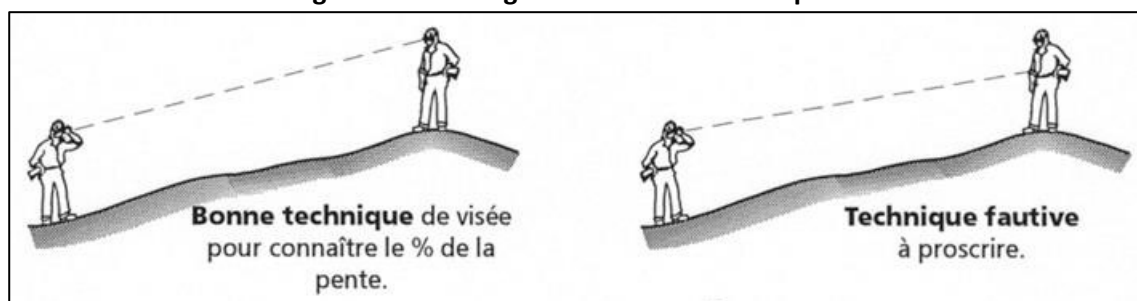
Figure 68 Mesurage de l'inclinaison de la pente
