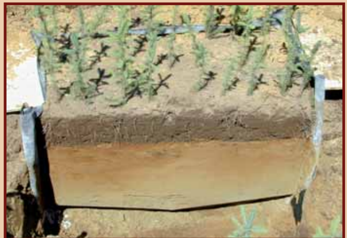
Dispositif de cases lysimétriques (bloc de sol non remanié sur un lysimètre passif) à la pépinière de Grandes-Piles. (J. Gagnon, MRNF)
