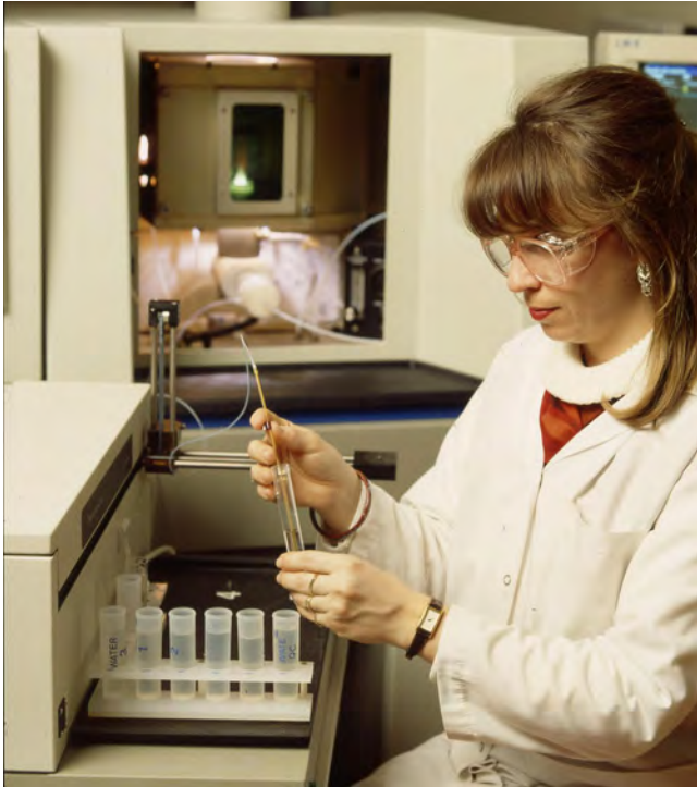
Analyse des tissus végétaux par spectrométrie d'émission atomique au plasma par Martine Beaumont, technicienne au laboratoire.
