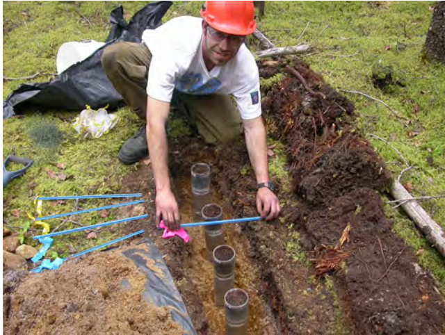
Installation de tubes de résine au lac Tirasse afin de mesurer la minéralisation de l'azote du sol (S. Marcouiller)
