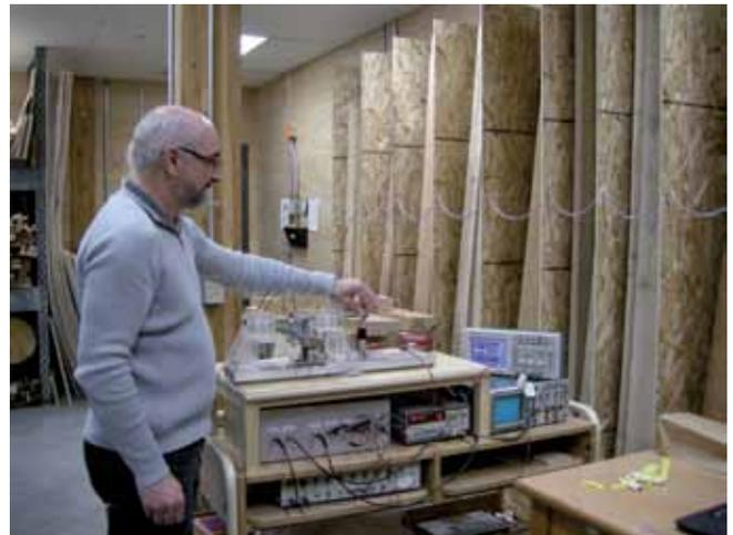
Mesure de la vitesse de propagation d'ultrasons sur un échantillon d'épinette noire en vue d'évaluer le module d'élasticité (MOE) du bois (M. Desponts, MRNF)
