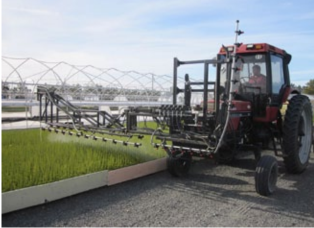
Dispositif de fertilisation foliaire d'urée sur des plants de fortes dimensions d'épinette noire 2 + 0 en récipients 25-310 produits à la pépinière de Normandin (Photo : J. Gagnon, MRNF).
