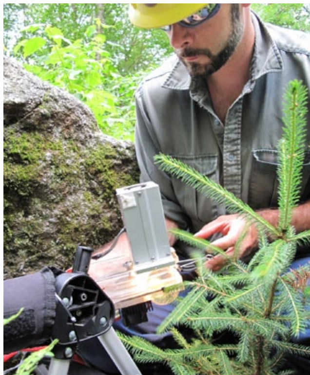
Mesure de la photosynthèse d'un semis d'épinette rouge planté dans une trouée sylvicole (Photo : H. Tremblay).
