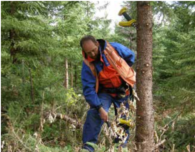
Évaluation acoustique de l'élasticité dynamique du bois dans un test clonal d'épinette noire de 15 ans en Gaspésie avec l'appareil Director® ST300 (Photo : M. Desponts, MRN).
