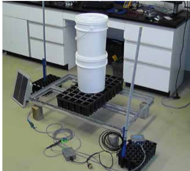
Réseau de pesons (balances) électroniques automatisés, installés en permanence sur le terrain et transmettant les mesures au bureau, en temps réel, par un réseau sans fil. Les masses mesurées sont converties en teneur en eau du substrat par le logiciel IRNET . Au premier plan, un peson avec son émetteur et une masse de référence de 50 kg (2 seaux blancs). À gauche, un routeur alimenté à l'énergie solaire. À l'arrière-plan, le récepteur relié à l'ordinateur (Photo : D. Girard, MRN).
