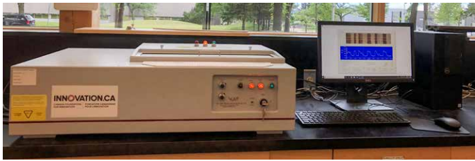
Figure 1. Densitomètre à rayons X (QTRS-01X Tree Ring Scanner) (photos : David Lagueux, Centre de recherche sur les matériaux renouvelables, Université Laval).
